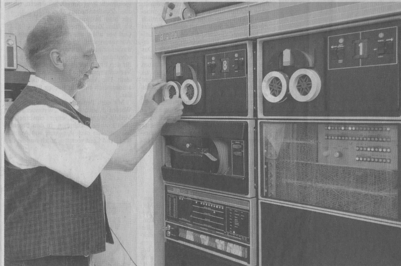
Von wegen Festplatte: Heribert Müllers alte Computer laden die Software noch von Magnetbändern.
