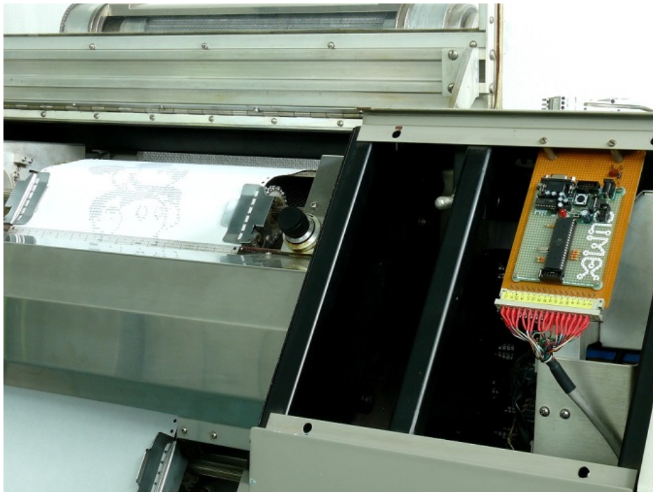
ABBILDUNG 5: Gut sichtbares Breakout-Board zu Demonstrationszwecken direkt am Drucker befestigt. Auf Knopfdruck erscheint in Windeseile eine ASCII-Art Mickey-Mouse (links im Bild).
