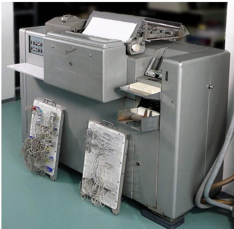
ABBILDUNG 2: Tabelliermaschine von vorne. Auf den weißen Tableaus im Vordergrund sieht man das mit Kabeln „gesteckte“ Programm.
