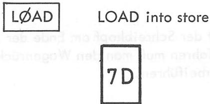
Dieser Befehl lädt den Inhalt einer oder mehrerer Karten in den Kernspeicher, normalerweise ein Programm oder eine Konstante.
