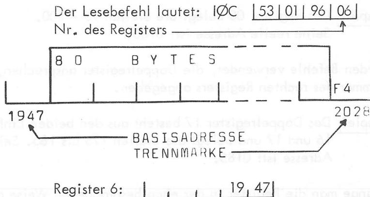
Wenn eine Zone von einem Befehl angesprochen wird, der komplette Zonen bearbeitet (Ein/Ausgabebefehl, Umschlüsselungsbefehle; s. 3.6. und 3.7.) muß sie durch eine Trennmarke F4 rechts von dem letzten benutzten Byte (s. obiges Beispiel) begrenzt werden. Diese Befehle können als Basisregister ein beliebiges Register von 00 - 99 bearbeiten.
