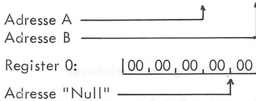
Die Halbbytes einer Stelle sind nicht adressierbar. Belegen zwei Zeichen dasselbe Byte, kann man nicht direkt auf eines von ihnen zugreifen. Man muß vorher mit dem entsprechenden Befehl diese zwei Zeichen auf zwei Bytes entpackt übertragen.
